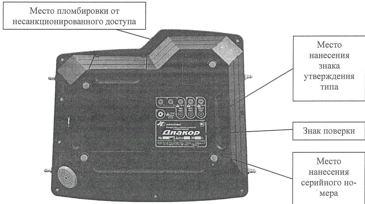
Рисунок 2 – Схема пломбировки от несанкционированного доступа, место нанесения знака утверждения типа и серийного номера
