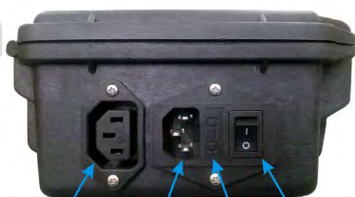
Выход на силовой модуль Вход 220 В Предохранитель Выключатель
