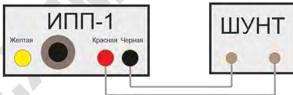
Рисунок 4 - Схема подключения измерителя потенциала поляризационного ИПП-1 «Менделеевец» при измерениях тока на внешнем шунте
