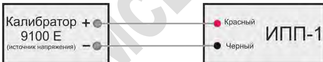
Рисунок 10 –Схема установки для определения диапазонов и основной абсолютной погрешности измерений напряжения постоянного тока
