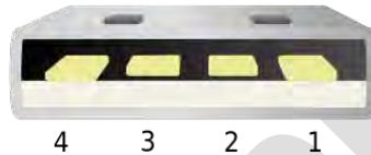
Рисунок 8 – Разъем USB тип А. Вид со стороны контактов. Нумерация контактов
