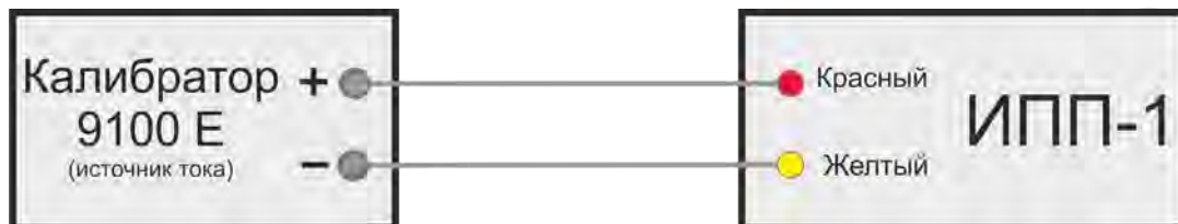
Рисунок 11 – Схема установки для определения диапазона и основной абсолютной погрешности измерений силы постоянного тока
