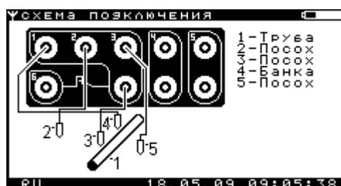
Рисунок 2.8.1.3.8 – Окно «Схема подключения прибора при проведении измерений»
