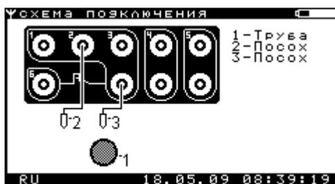
Рисунок 2.8.2.5 – Окно «Схема подключения прибора при проведении измерений»
