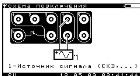
Рисунок 2.8.4.1 – Окно «Схема подключения прибора при проведении измерений»
