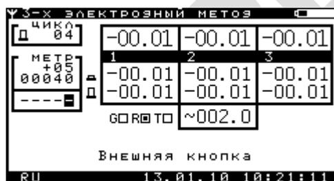
Рисунок 2.8.1.2.8 – Окно «Измерения двухэлектродным методом»
