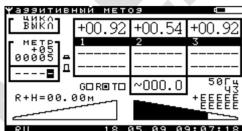
Рисунок 2.8.1.3.9 – Окно «Измерения трехэлектродным методом»
