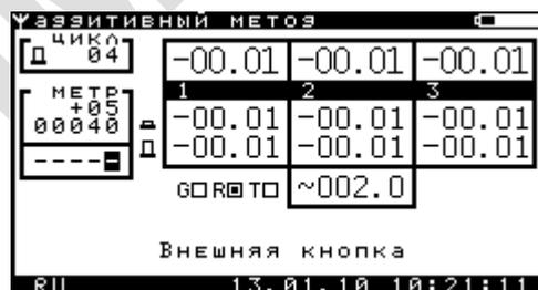
Рисунок 2.8.1.3.11 – Окно «Измерения двухэлектродным методом»
