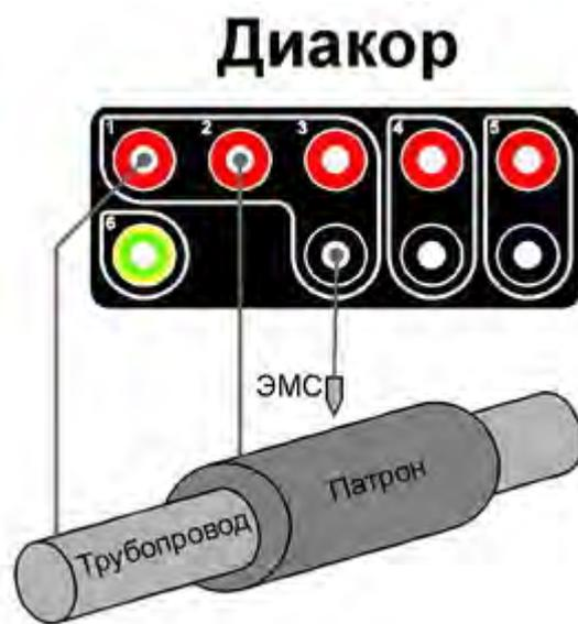
Рисунок 2.13.6.1 - Схема установки прибора на дорожном переходе
