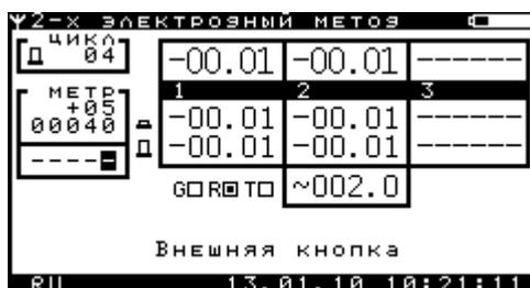
Рисунок 2.8.1.1.8 – Окно «Измерения двухэлектродным методом»
