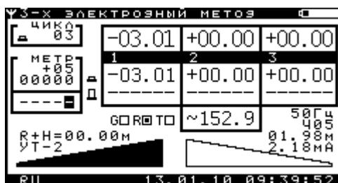
Рисунок 2.8.1.2.6 – Окно «Измерения трехэлектродным методом»
