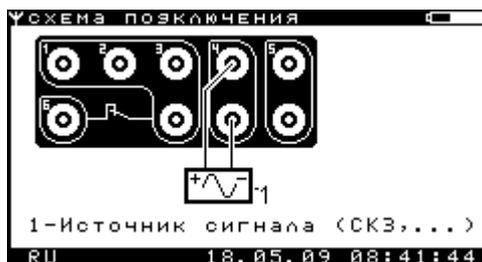
Рисунок 2.8.5.2 – Окно «Схема подключения прибора при снятии осциллограмм»
