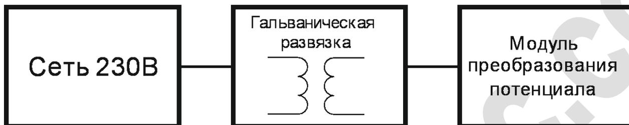
Рисунок 1 – Структурная схема преобразователя
