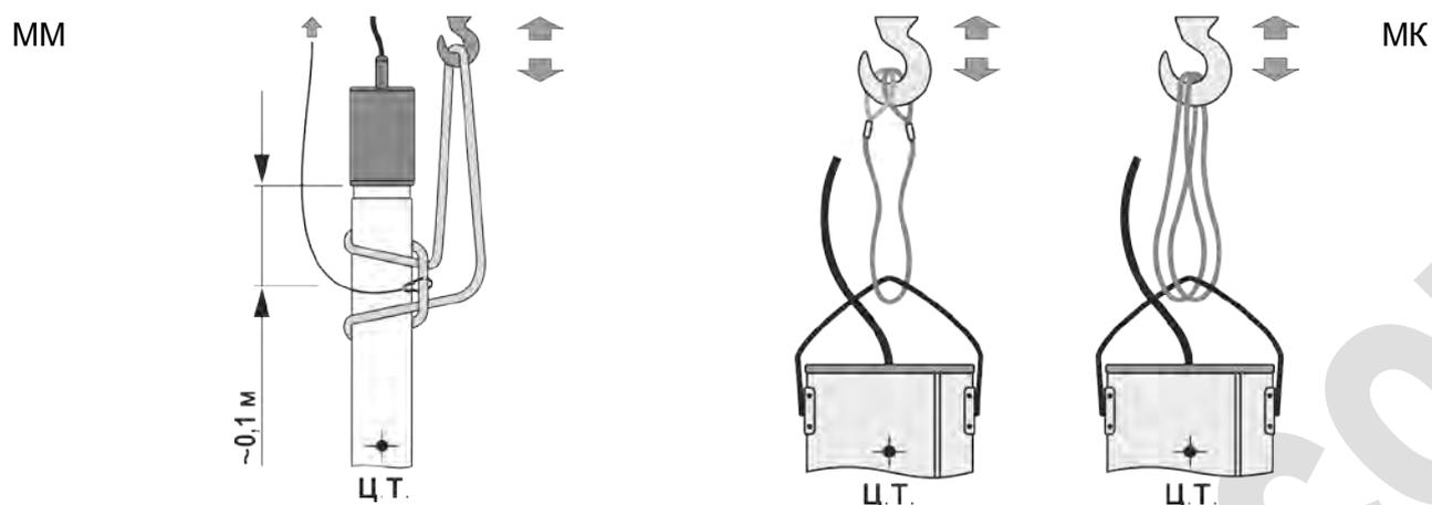
Рисунок 4 – Схема строповки заземлителей ММ и МК при установке в скважину
