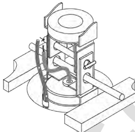
Рисунок 7 – Схема стыковки заземлителей в устье скважины
