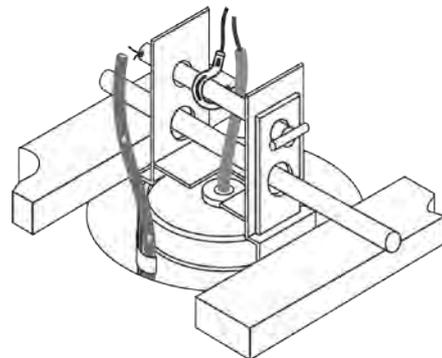
Рисунок 6 – Схема фиксирования заземлителя в устье скважины
