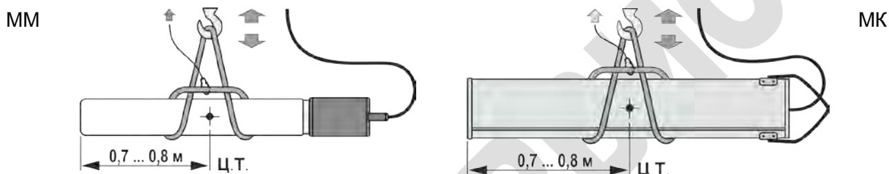
Рисунок 2 – Схема строповки заземлителей конструктивного исполнения ММ и МК при укладке в траншею
