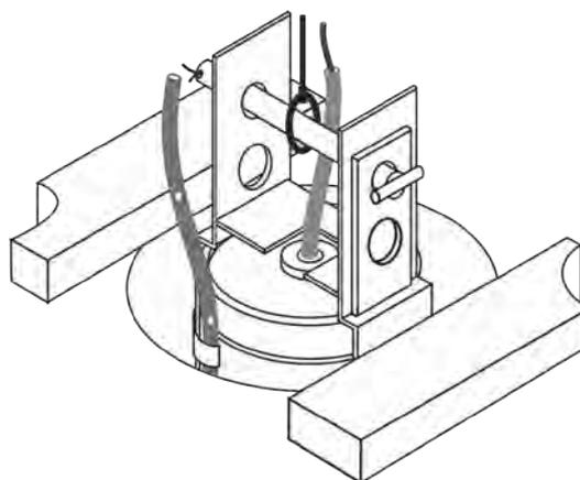
Рисунок 8 – Схема строповки гирлянды заземлителей
