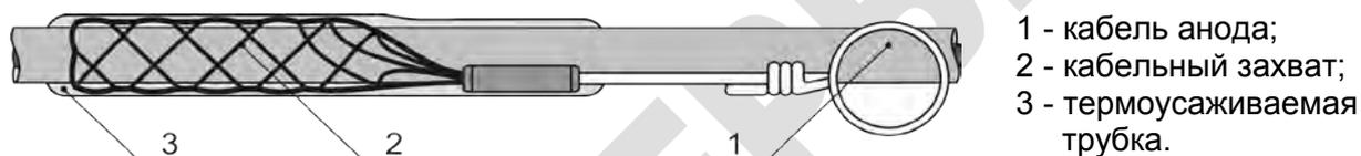
Рисунок 12 – Кабельный захват (исполнение 2)
