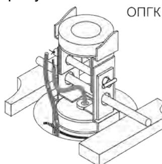
Рисунок 7 – Схема стыковки анодов в устье скважины
