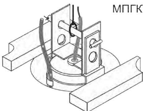
Рисунок 9 – Схема строповки гирлянды анодов
