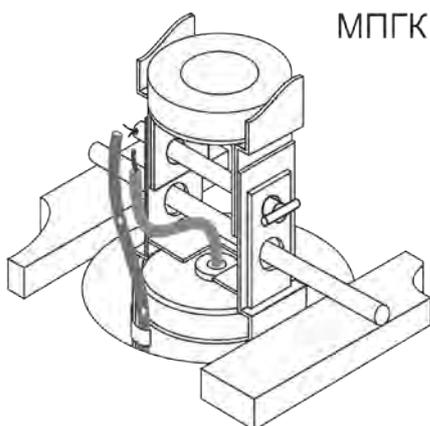
Рисунок 8 – Схема стыковки анодов в устье скважины
