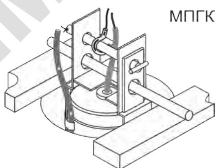
Рисунок 7 – Схема фиксирования анода в устье скважины
