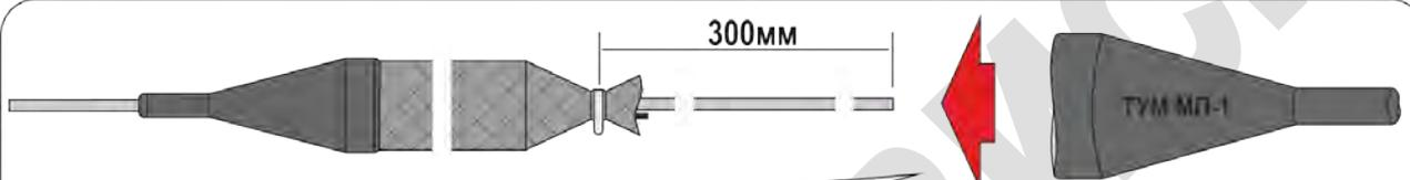
Установить на срез электрода (рабочего элемента) протяженного анода термоусаживаемую муфту переходного диаметра с маркировкой: ТУМ МП-1
