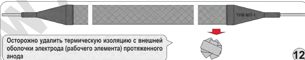
Осторожно удалить термическую изоляцию с внешней оболочки электрода (рабочего элемента) протяженного анода
