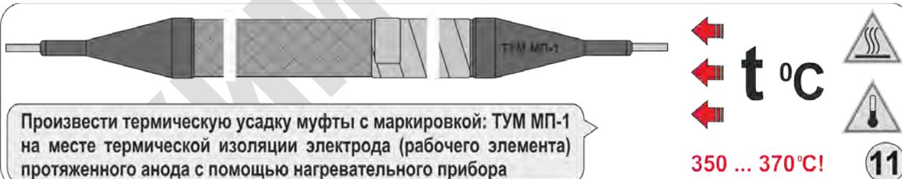
Произвести термическую усадку муфты с маркировкой: ТУМ МП-1 на месте термической изоляции электрода (рабочего элемента) протяженного анода с помощью нагревательного прибора
