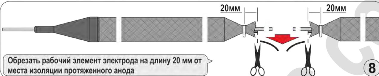
Обрезать рабочий элемент электрода на длину 20 мм от места изоляции протяженного анода
