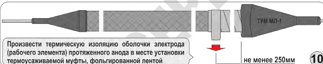
Произвести термическую изоляцию оболочки электрода (рабочего элемента) протяженного анода в месте установки термоусаживаемой муфты, фольгированной лентой
