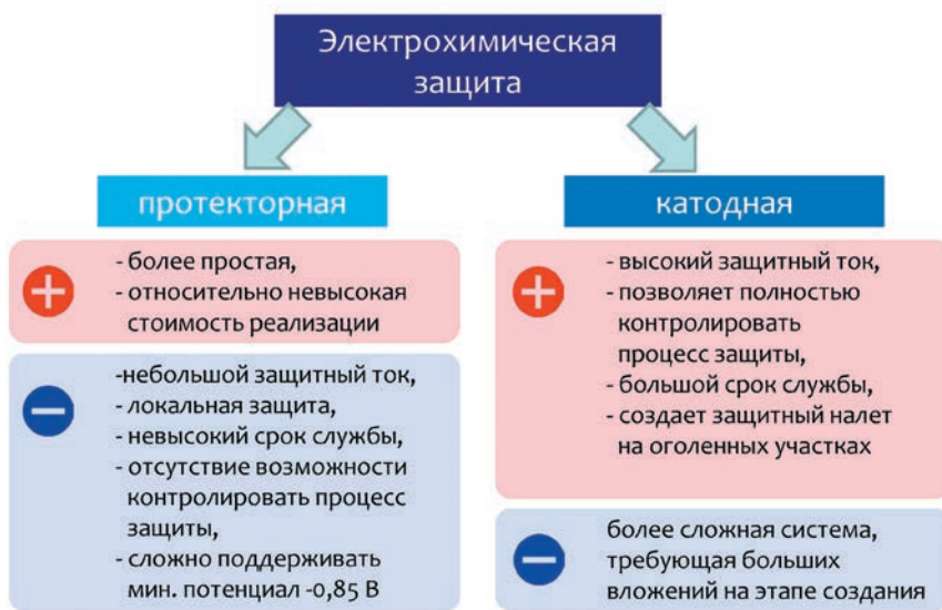
Рис. 2. Виды электрохимической защиты
